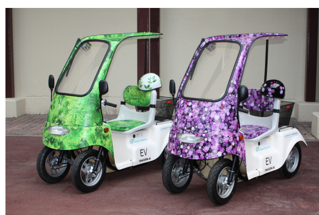
図: 実験で使用している超小型電気自動車「彩リイヴ」。原動機付自転車免許で運転可能で、最高時速は機構的に30km/h強に厳しく制限されている。
